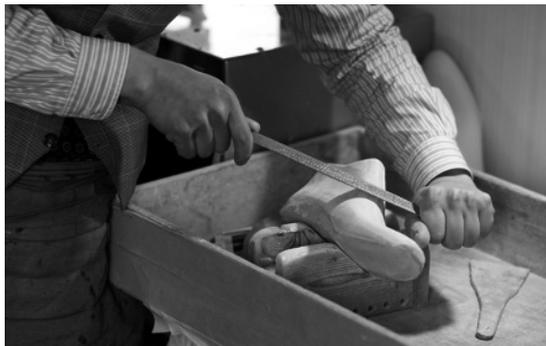
靴型（木型）の修正作業。試し履きを考慮した上で、木型を微調整し、もう一度試し履きを行い、改めて左右のバランスをチェックする
